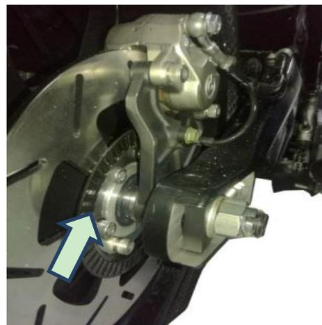
La méthode pour vérifier les plaquettes de frein arrière consiste à examiner si elles sont usées jusqu'à la limite marquée. Si elles dépassent la limite, il faut les remplacer par de nouvelles plaquettes.
