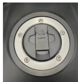
Pour ouvrir le capot du réservoir de carburant, insérez la clé et tournez-la de 90° dans le sens des aiguilles d'une montre, puis tirez le capot avec la clé.
