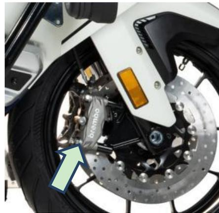
Pour vérifier l'état des plaquettes de frein avant, il faut vérifier si elles sont usées jusqu'à la limite marquée. Si elles ont dépassé cette marque, il est nécessaire de les remplacer par des neuves.
